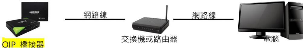
2. 通過網路線直接連接，需修改鍵盤/ 電腦 IP 位址且設定相同網段
